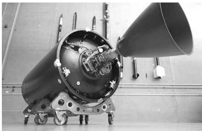
Рисунок 3 – Вторая ступень ракеты Electron Фото Rocket Lab
