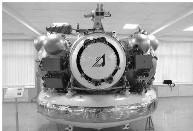
Рисунок 2 – Межорбитальный буксир «Фрегат» производства НПО им. С.А. Лавочкина
