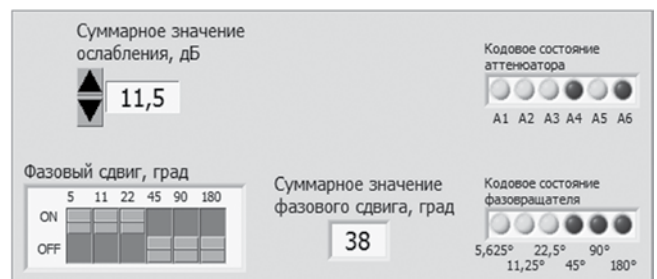
Рисунок 4 – Лицевая панель виртуального прибора для управления субмодулем
