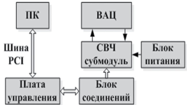
Рисунок 3 – Структурная схема системы функционального контроля субмодулей ППМ
