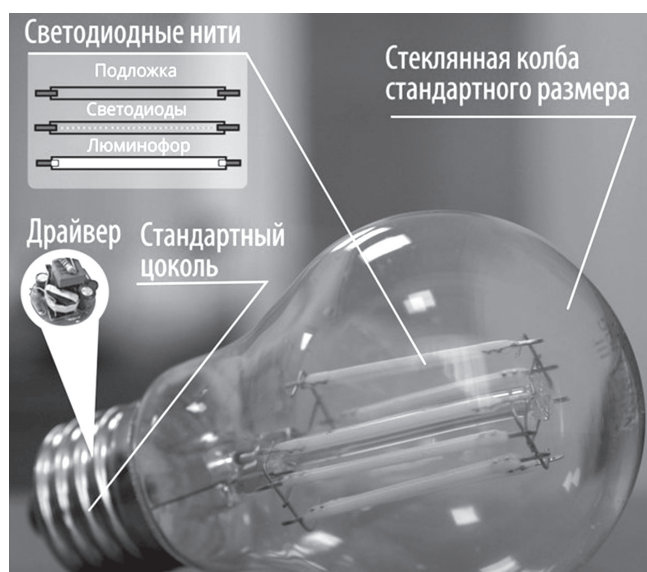
Рисунок 3 – Устройство филаментной лампы
