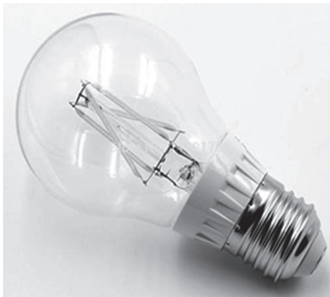
Рисунок 4 – Под кольцом между колбой и цоколем скрывается дополнительное место для высококачественного драйвера
