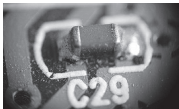
Рисунок 15 – Конденсатор поверхностного монтажа на плате, макрофотография
