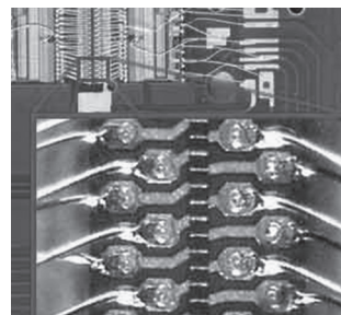
Рисунок 3 – Фрагмент светодиодной линейки при увеличении
