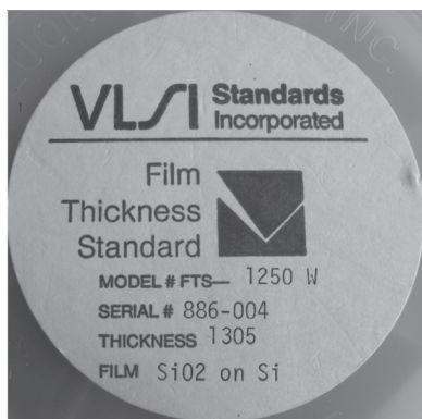
Рисунок 4 – Контрольный образец оксида кремния ( \text{SiO}_2 ) с толщиной 130 нм
