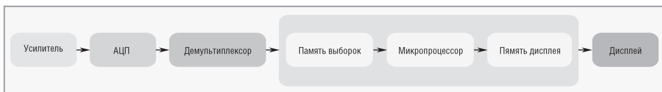
Рисунок 5 – Архитектура последовательной обработки цифрового запоминающего осциллографа
