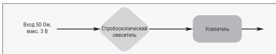
Рисунок 9 – Архитектура стробоскопического осциллографа
