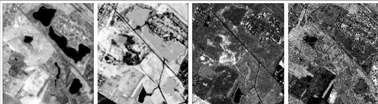
Рисунок 3 – Изображения четырех компонент, полученных в результате преобразования многозонального космического снимка по методу главных компонент
