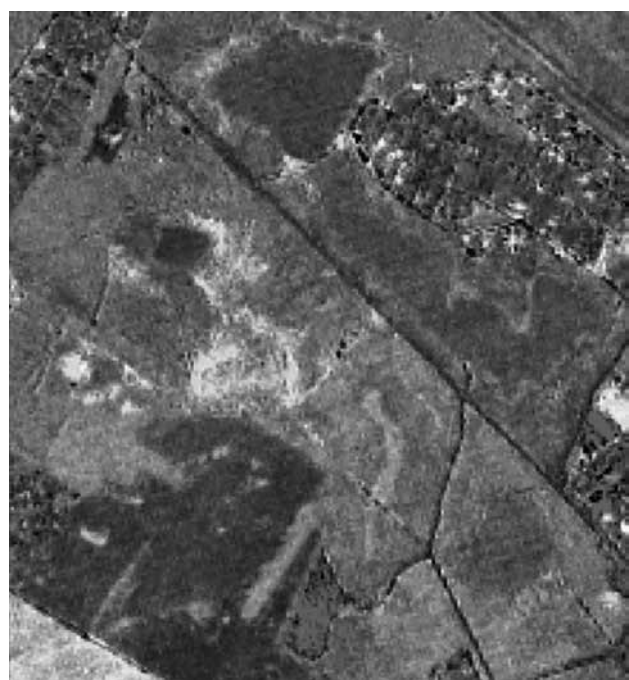
Рисунок 4 – Композитное изображение, полученное в результате преобразования многозонального космического снимка по методу главных компонент
