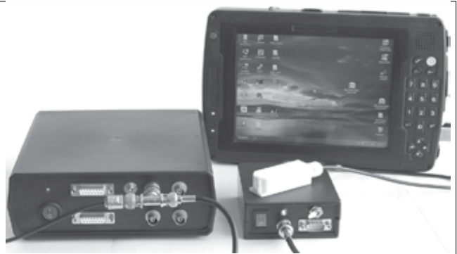
Рисунок 5 – Система для регистрации переменных магнитных полей с преобразователем переменного магнитного поля индукционного типа №2
