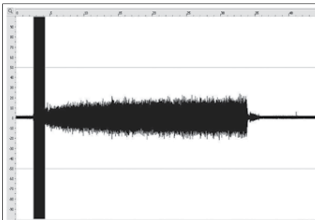
Рисунок 6 – Сигнал, полученный при помощи преобразователя магнитных полей №2, установленного на кронштейне, на уровне критического сечения модельного ЖРД во время его огневого испытания
