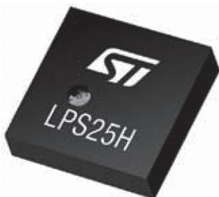
Рисунок 6 – LPS25H – новый миниатюрный датчик давления для мобильных применений
