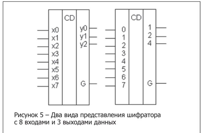
котором явно отображается, что нижний разряд имеет вес 4, средний – вес 2, а верхний – вес 1. Выходы обозначаются числами от 0 и до 7, которые только и можно получить при всех возможных комбинациях нулей и единиц на входах (в частности, 000 соответствует числу 0, а 111 – числу 7).
