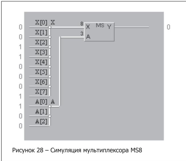
Рисунок 28 – Симуляция мультиплексора MS8
