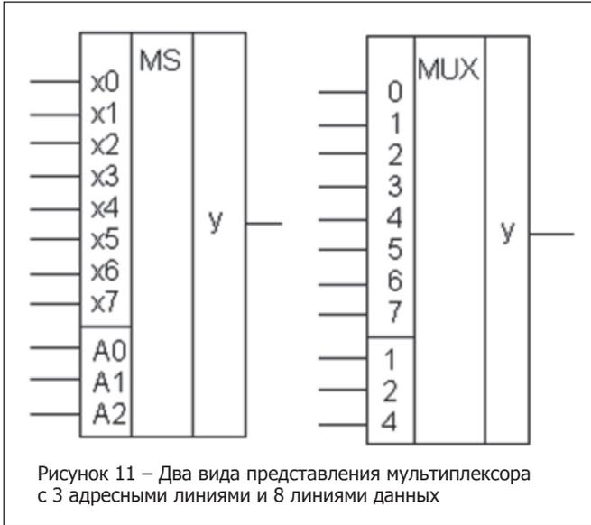
Рисунок 11 – Два вида представления мультиплексора с 3 адресными линиями и 8 линиями данных
