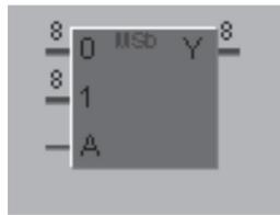
Рисунок 22 – Мультиплексор MSb8x2
