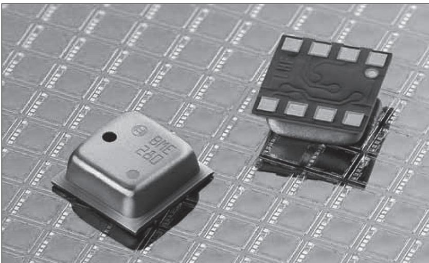
Рисунок 8 – BME280 – первый MEMS-комбидатчик давления, влажности и температуры
