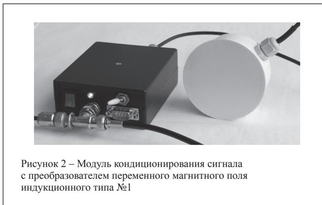
Все преобразователи выполнены в виде многослойных цилиндрических катушек без магнитных сердечников. Для снижения уровня паразитных наводок, на внутренней стороне их корпусов выполнены электростатические экраны из алюминиевой фольги в конструк-
