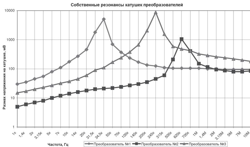
Рисунок 4 – Зависимости размаха напряжения на катушках преобразователей №№ 1–3 от частоты
