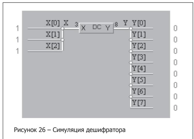
Рисунок 26 – Симуляция дешифратора
