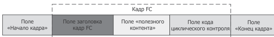
Рисунок 1 – Структура кадра ADVB (Fibre Channel)
