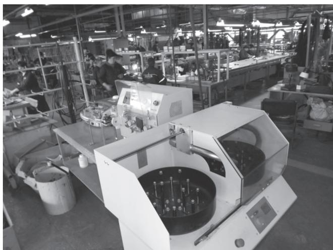
Линия мерной резки и маркировки проводов (Швейцария)
