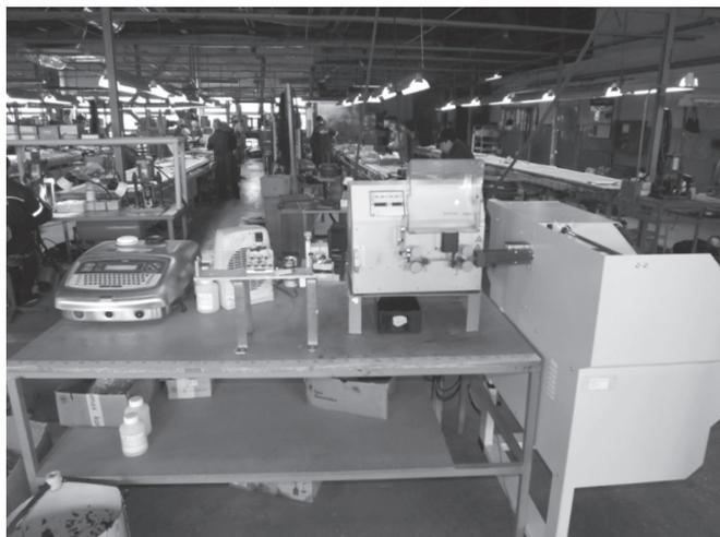
Цех резки, маркировки, сборки и опрессовки проводов электронных и электрических жгутов
