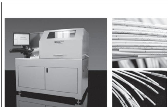
Рисунок 4 – Установка лазерной зачистки и маркировки
