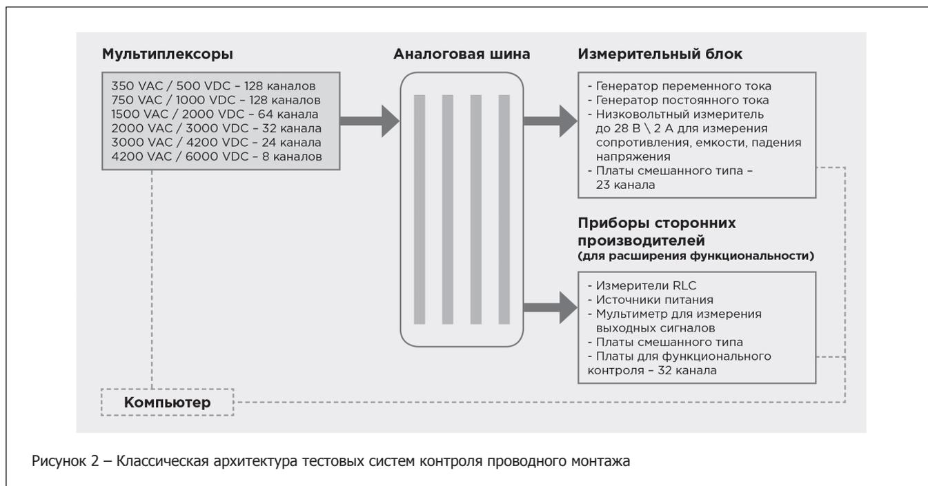
Рисунок 2 – Классическая архитектура тестовых систем контроля проводного монтажа
