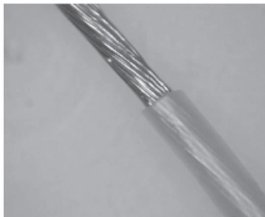
Рисунок 3 – Провод МГТФ с сечением 0,07 мм<sup>2</sup>, обработанный на автомате Schleuniger ES9320 (Schleuniger AG)
