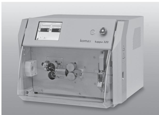
стоит только в возможности старших машин обрабатывать провод с большим сечением. Особняком в линейке стоит машина Komax Карра 322, которая позволяет зачищать не только наружную изоляцию, но и внутреннюю изоляцию многожильного провода, такого, как ПВС.
