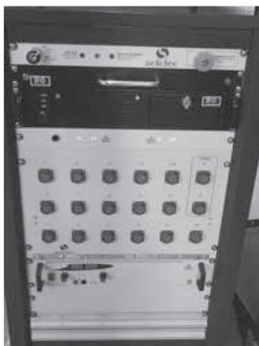
Рисунок 4 – Пример оснастки – интерфейс под разъемы заказчика
