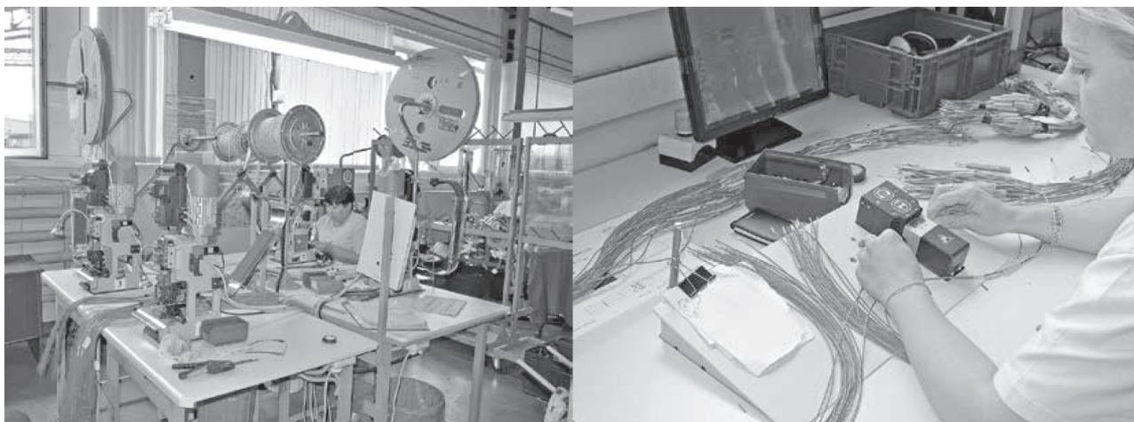
Участок полуавтоматической опрессовки, оснащенный прессами Mecal; установка ультразвуковой сварки
