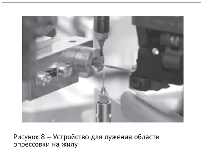
Для выполнения этих операций применяются как настольные установки, в которые провода с опрессованными контактами закладываются вручную, так и автоматизированные модули, производящие лужение обжатой области непосредственно после опрессовки (рисунок 8).
