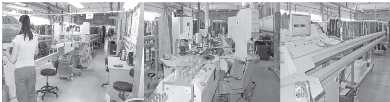
Автоматическая линия Alpha 355 с длинным рабочим столом.
