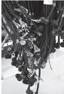
Когда армированные отрезки проводов подготовлены, они комплектуются на столе в жгут. Перед этим на столе закрепляется графическая цветная схема жгута в натуральную величину. При большом количестве проводов, столы устанавливаются на конвейер, где сборкой жгута занимаются до двух десятков человек, каждый из которых отвечает за свой участок.
