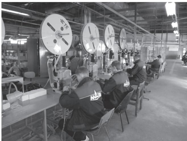
Опрессовка контактов проводов на прессах «Mecall TT» (Швейцария)
