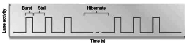
Рисунок 7 – Переключение режимов работы: Lane activity – активность линии; Burst – взрывной режим; Stall – остановка; Hibernate – гибернация; Time (s) – время, с
