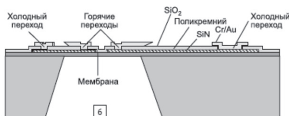
Рисунок 8 – Высокочувствительный мобильный МЭМС ИК тепловой детектор, разработанный Omron: а) контроль остывания чашки с горячим напитком; б) измерительный принцип теплового ИК-датчика (поперечное сечение сенсорного кристалла); в, г) в основе тепловых датчиков D6T – две версии матриц МЭМС-элементов 4×4 (D6T-44L-06) и матрицы-столбца 1×8 (D6T-8L-06);
