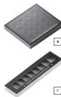
Рисунок 8 – Высокочувствительный мобильный МЭМС ИК тепловой детектор, разработанный Omron: а) контроль остывания чашки с горячим напитком; б) измерительный принцип теплового ИК-датчика (поперечное сечение сенсорного кристалла); в, г) в основе тепловых датчиков D6T – две версии матриц МЭМС-элементов 4×4 (D6T-44L-06) и матрицы-столбца 1×8 (D6T-8L-06);
