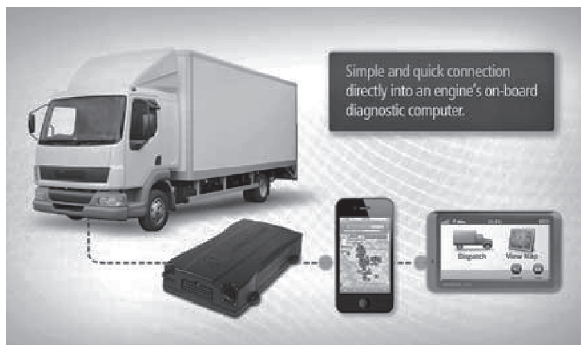
Рисунок 8 – Бортовое аппаратное решение от Networkfleet: GPS-трекер с диагностическими функциями, смартфон, GPS-навигатор
