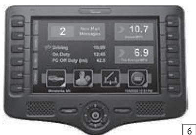
Рисунок 2 – Примеры современных бортовых самописцев (EOBR) и бортовых компьютеров (OBC): а) Qualcomm EOBR 101; б) бортовой компьютер с функциями OBR People Net BLU.2
