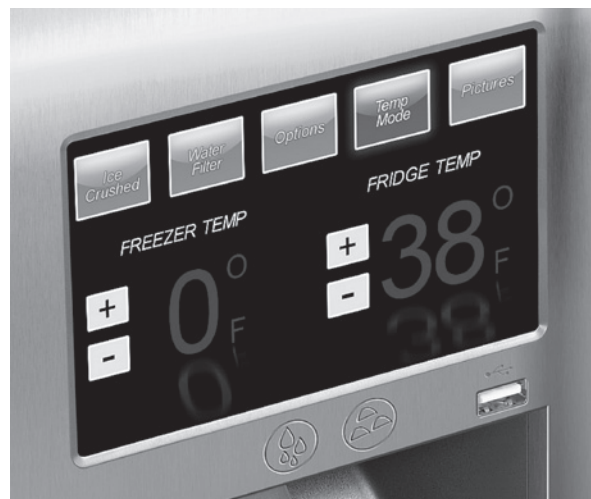
Рисунок 2 – Soft-кнопки в простом интерфейсе дают пользователям больше информации и возможностей для управления
