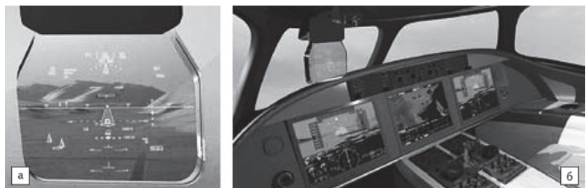
Рисунок 3 – HUD-система Rockwell Collins HGS-3500: а) внешний вид; б) вид в кабине
