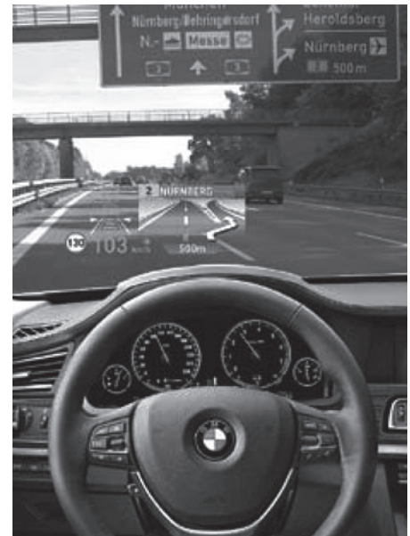
Рисунок 7 а – Контактно-аналоговые HUD в автомобилях BMW: стандартные возможности
