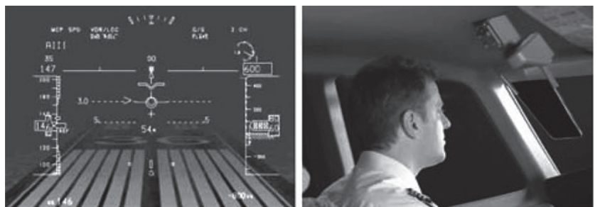
Рисунок 4 – Иллюстрация технологии Q-HUD от BAЕ Systems
