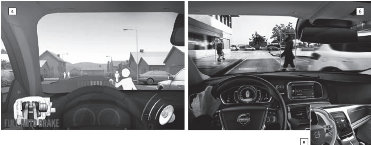
Рисунок 11 – HUD от Volvo в системах защиты пешеходов и другие дисплейные технологии: а) принцип работы функции распознавания пешеходов с полным автоматическим торможением; б) обнаружение пешеходов посредством камеры переднего обзора, вывод информации на HUD (мерцающий свет) и Volvo Sensus (предупреждение об автоматическом торможении); в) touch-экран Concept You, связанный с HUD
