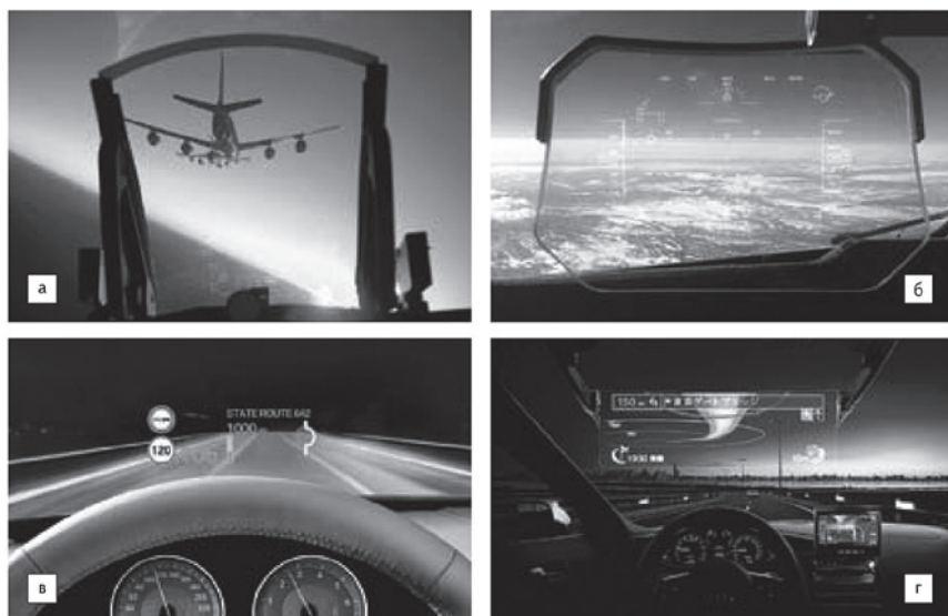
Рисунок 1 (а–г) – Ключевые применения HUD/HMD: а) HUD в военном истребителе F16 Lockheed Martin; б) коммерческий авиационный HUD Elbit Systems; в) стандартный вид современного HUD, применяющегося в автомобилях BMW; г) новое применение технологии HUD для автомобильной навигации (источник: Pioneer);
