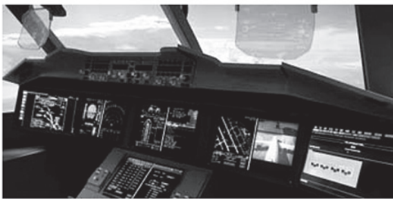
Рисунок 2 – Применение системы HUD от Thales на самолете Airbus A350-XWB
