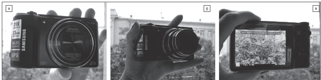
Рисунок 1 – Смарт-камера Samsung WB850F 16,2 Мп с 23 мм линзой и 21x оптическим зумом, с функцией Full HD захвата видео, оснащенная GPS/Wi-Fi: а) корпус DSC-камеры; б) камера в работе; в) активная функция GPS
