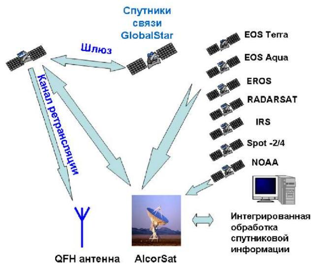
Рис. 2. Наземный комплекс приема и обработки данных целевой аппаратуры образовательных микроспутников
