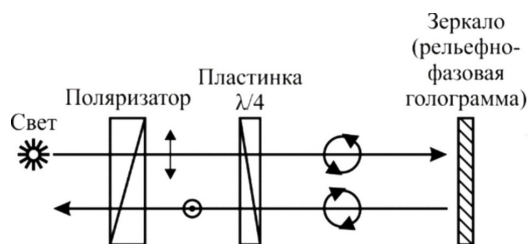
Рис. 1. Оптическая схема полярископа для визуализации юниграмм
