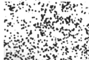
Рис. 3. Авторадиограмма-реплика, снятая с центральной части поверхности после насыщения <sup>41</sup>Ar, 16 ч,  $\times 2\ 800$ .
