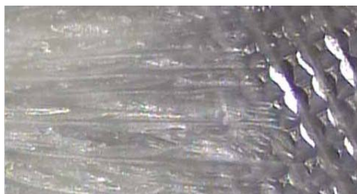
Рис. 3. Вид края пленки \text{TeO}_2 на поверхности платиновой подложки.
