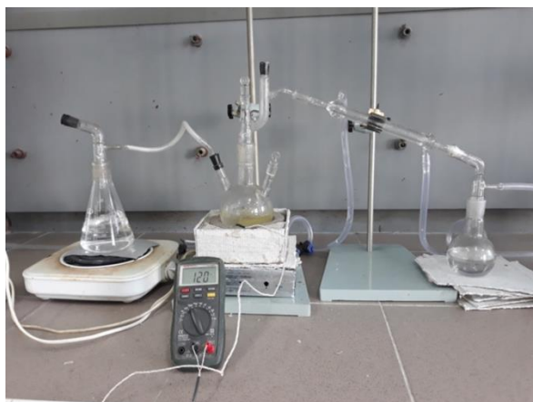
Рисунок – Экспериментальная установка для выделения скипидара из сосновой живицы
