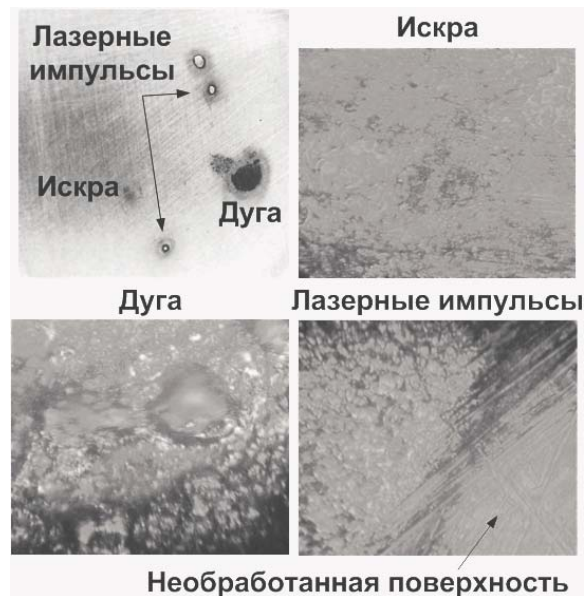
Рис. 1. Фотографии образца, диаметром 3 см, а также снимки его поверхности после воздействия электрической искры, дуги и лазерных импульсов с увеличением в 300 раз, полученные с помощью микроинтерферометра Линника
