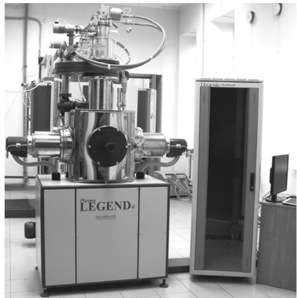
Рис. 1. Внешний вид технологического комплекса процессов вакуумно-плазменного легирования поверхности металлоизделий «ЛЕГЕНДА»
