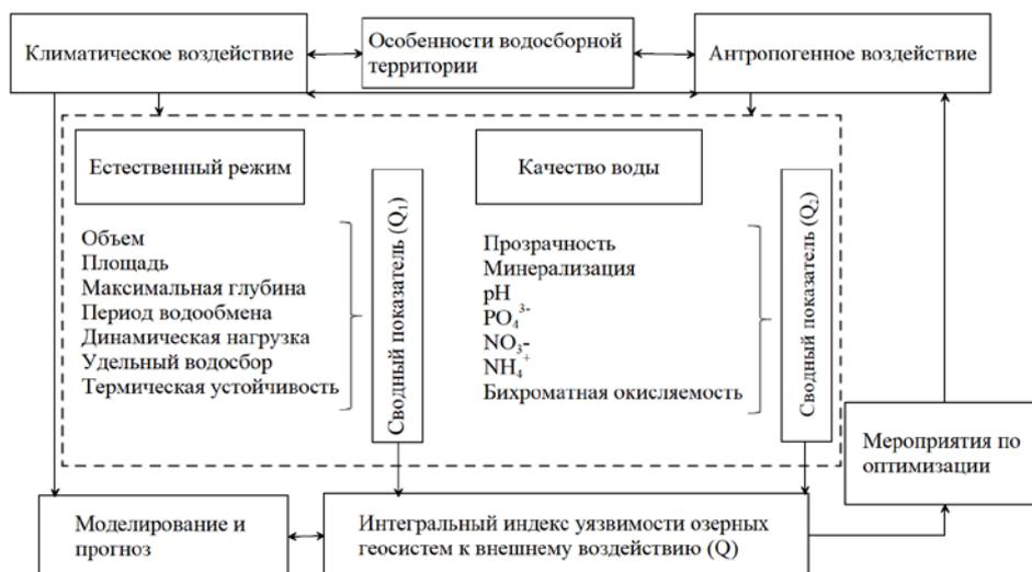
**Рисунок 1. – Влияние различных факторов на уязвимость озерных геосистем к внешнему воздействию**
