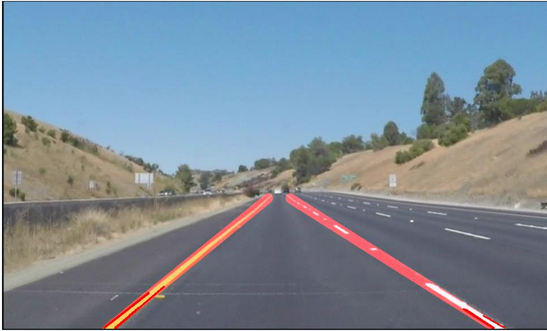
Рисунок 2. Результат определения полосы движения
