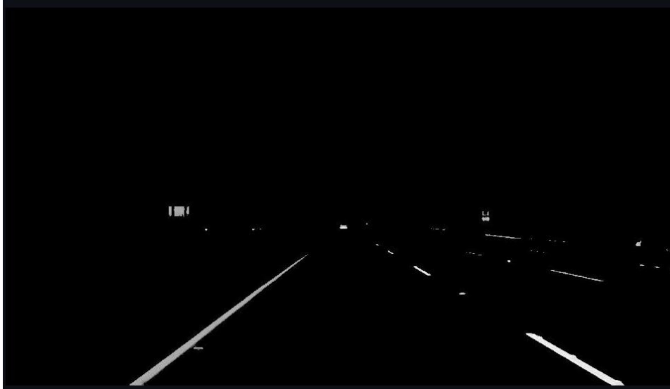
Рисунок 1. Результат детектирования контуров объектов
