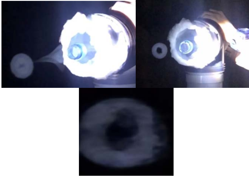
Рис. 2. Фотографии процесса образования и движения дымовых колец
