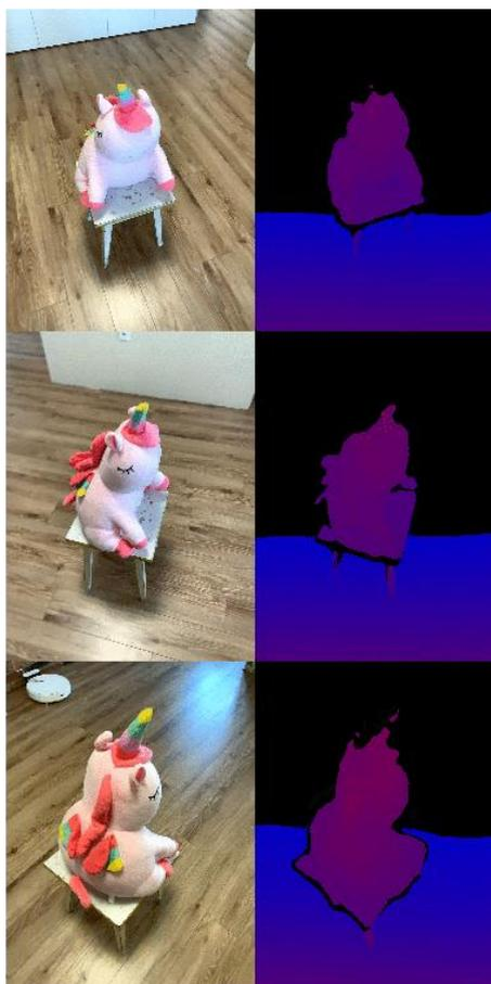
Рисунок 1. Кадры, полученные в результате RGBD-сканирования с помощью Apple Lidar.
