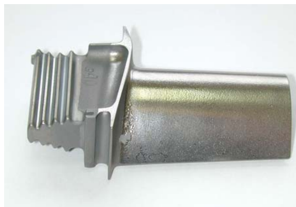
Рис. 1. Внешний вид дефектной лопатки турбины из сплава ЖС26НК с NiCrAlY вакуумно-плазменным покрытием после облучения.
