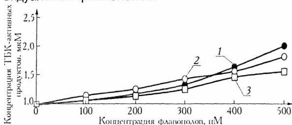
Рис. 1. Зависимость образования ТБК-активных продуктов ПОЛ от концентрации кверцетина (1), рутина (2) и морина (3) в реакции пероксидазной биотрансформации. Время инкубации – 20 мин
