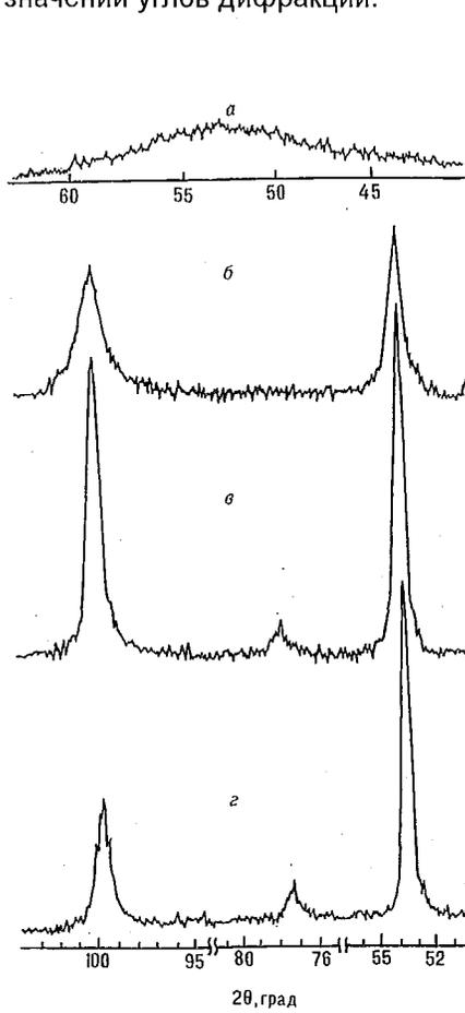
Рис.3. Фрагменты рентгенограмм пленок железа (а) и сплава железо-бор, содержащих бора (ат.%):
