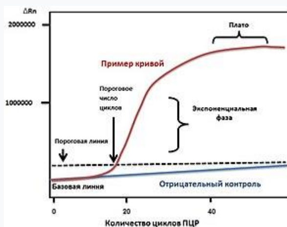
Рисунок 20 - График амплификации в кПЦР
