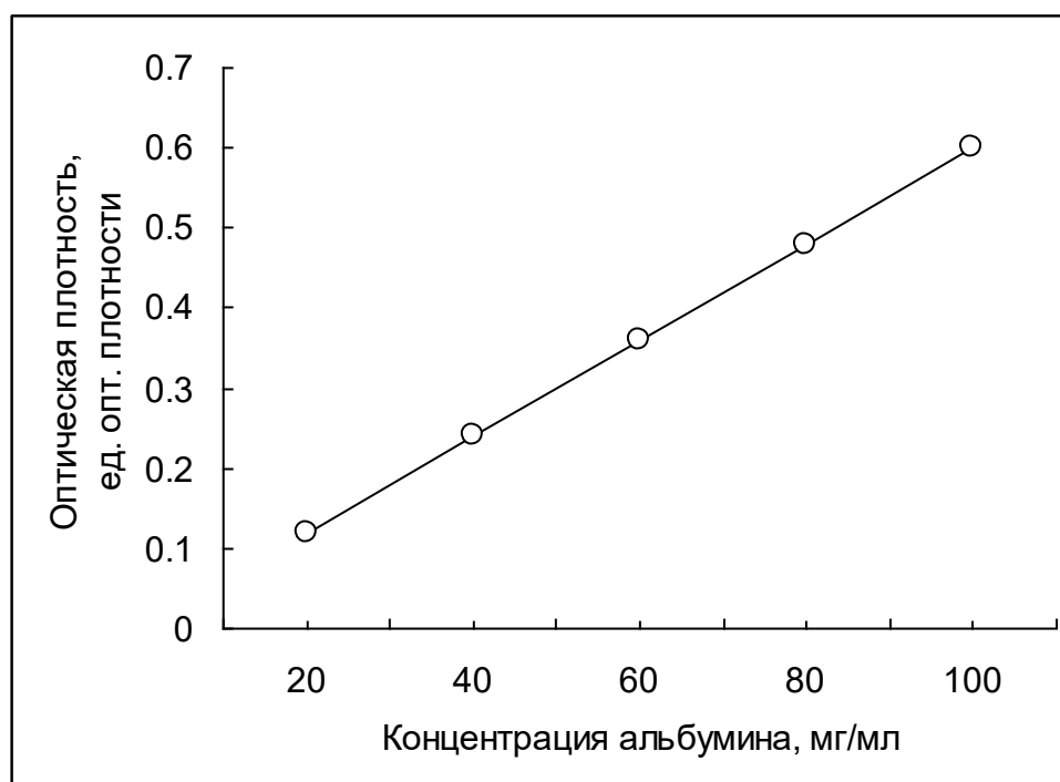
Рисунок 27 - Калибровочная прямая для определения содержания альбумина в сыворотке крови крыс.
