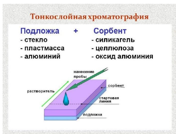
Рисунок 14 - Схема тонкослойной хроматографии.
