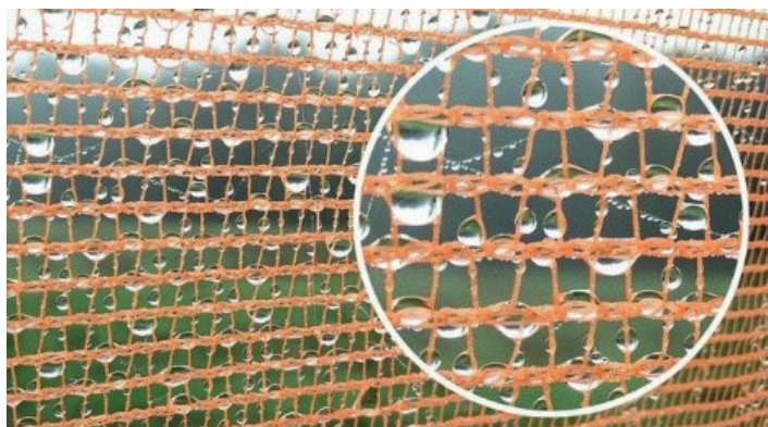
Рис. 2. Структурные переплетения водосборника– Warka Water
