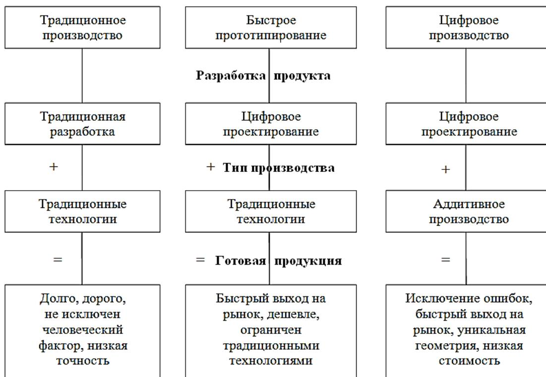
Рисунок 1 – Различия в традиционном и аддитивном производстве
