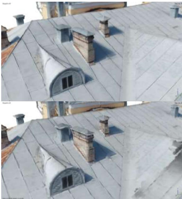
Рисунок 3 – Сравнение тайловой (сверху) и полигональной (снизу) моделей построения 3D-объектов на примере мелких деталей объекта (крыши дворца)
