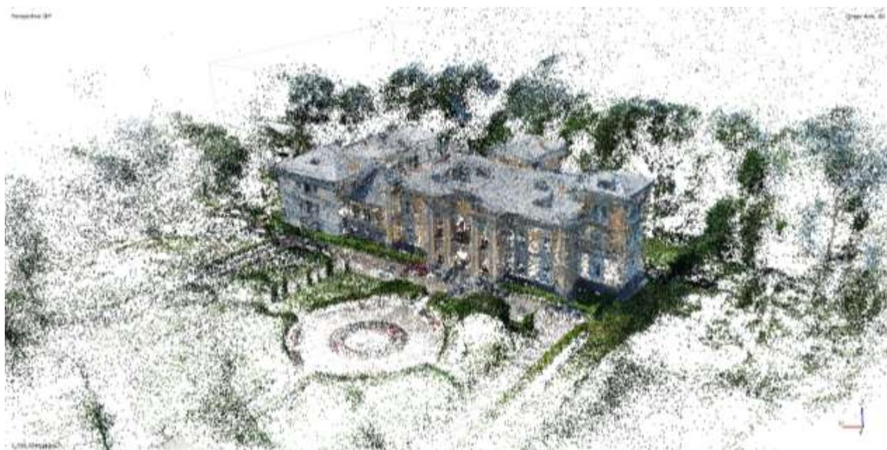
Рисунок 1 – Результат построения плотного облака точек
