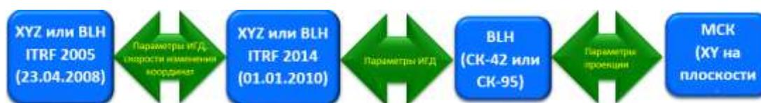
Рисунок 1 - Схема определение параметров связи
