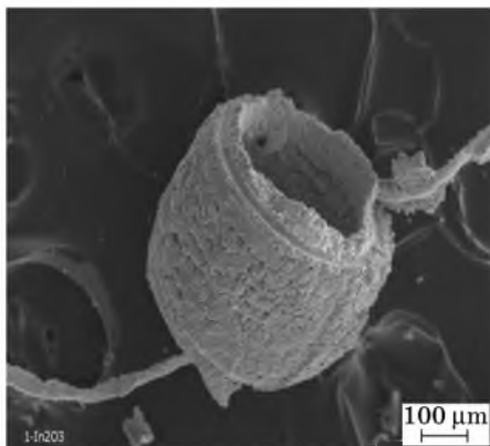
Рис. 5. SEM-изображение чувствительного элемента на основе \text{In}_2\text{O}_3
