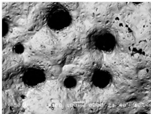
Рис. 2. Микрофотография анодного покрытия \text{PbO}_2\text{—SnO}_2 , осажденного из электролита при соотношении C_{\text{Pb}^{2+}} : C_{\text{Sn}^{2+}} = 1 : 1
