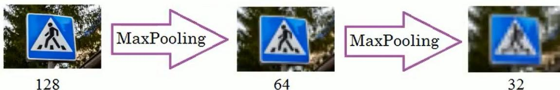
Рисунок 2.12 – Результат применения операции maxpooling
