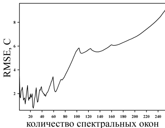
Рис. 2. – Зависимость среднеквадратичного отклонения калибровки температуры по проверочной выборке от количества спектральных окон, учитываемых в модели, для нормированных на максимум спектров флуоресценции активированного ионами неодима нанокристаллического порошка оксида иттрий-гадолиния.
