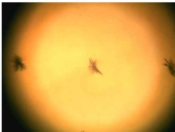
Рис. 1. – Пример фотографии областей пробоя в четвертом слое шестого массива.
