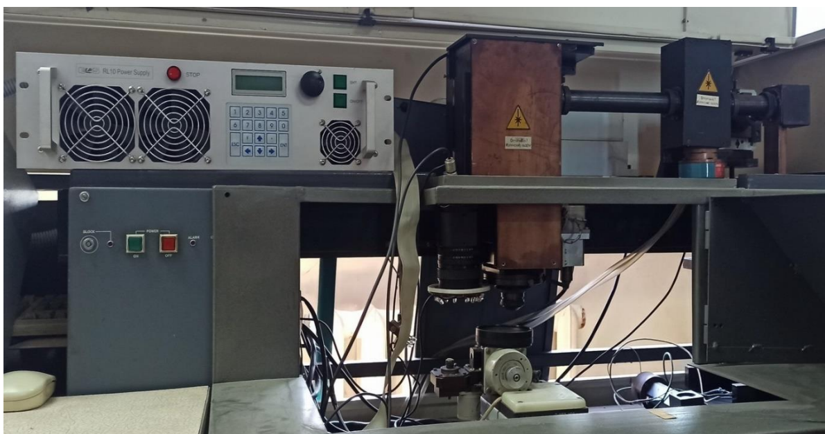
Рис. 4 – Установка для термохимической обработки сверхтвердых материалов
