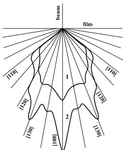
Рис. 1. Полярные диаграммы углового распределения ионов  $\text{Na}^+$ , прошедших через монокристаллическую пленку Al(100),  $d=45$  нм при разных энергиях: 1-  $E_0 = 20$  кэВ; 2-  $E_0 = 30$  кэВ
