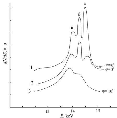
Рис. 2. Энергетическое распределение ионов  $\text{Na}^+$ , прошедших через пленку Al(100) при разных углах падения ионного пучка  $\varphi$ : 1- $0^\circ$ , 2- $5^\circ$ , 3- $10^\circ$ ;  $d_{\text{Al}}=45$  нм. Энергия первичных ионов 20 кэВ
