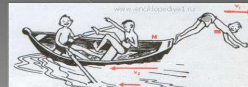
Рис. 4. По закону о сохранении движения  $(m+M)v = mv_1 + Mv_2$ .
