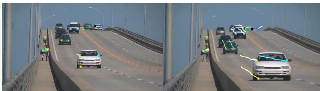
Рис. 1. Визуализация оптического потока на примере для точек интереса на 1-ом и k-ом кадре
