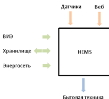
Рис. 1. Схематическое представление системы управления энергоэффективностью жилища.
