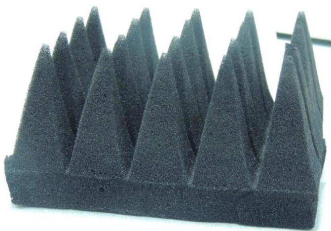
Рис. 1. Фото пирамидального радиопоглощающего композитного материала на основе пенополиуретана, акрилового сополимера и углеродных нанотрубок «Таунит-МД»
