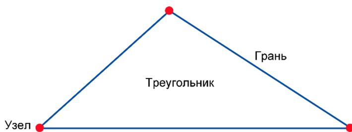
Рисунок 14 – Элементы треугольника TIN-модели
