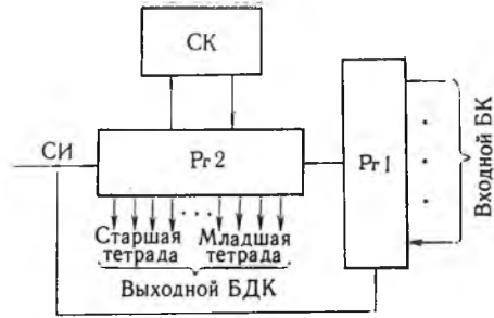
Рис. 1. Структурная схема последовательного преобразования БК \rightarrow БДК :
