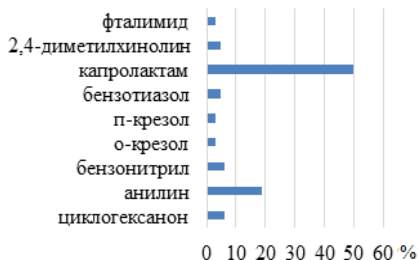
Рисунок 1. – Относительное содержание основных компонентов пиролизной воды
