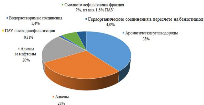
Рисунок 7. – Ориентировочный состав пиролизного масла, полученного в среде азота
