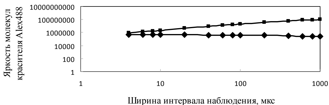
Рис. 3. График зависимости яркости молекул красителя Alex488 от ширины интервала наблюдения без коррекции ■ и с коррекцией ◆
