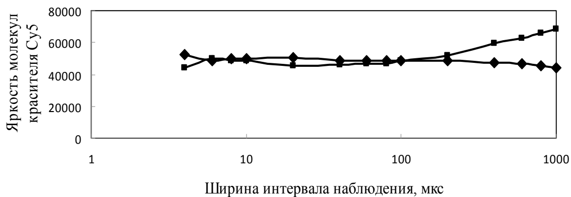
Рис. 2. График зависимости количества молекул белка в исследуемом объеме от ширины интервала наблюдения без коррекции ■ и с коррекцией ◆
