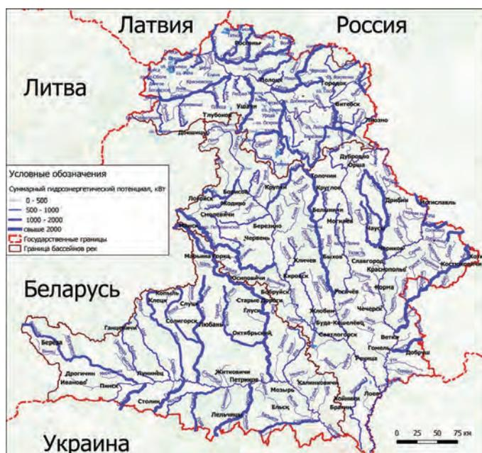
Рисунок 3 – Суммарный гидроэнергетический потенциал средних и малых рек в бассейнах рек Западная Двина, Днепр и Припять
