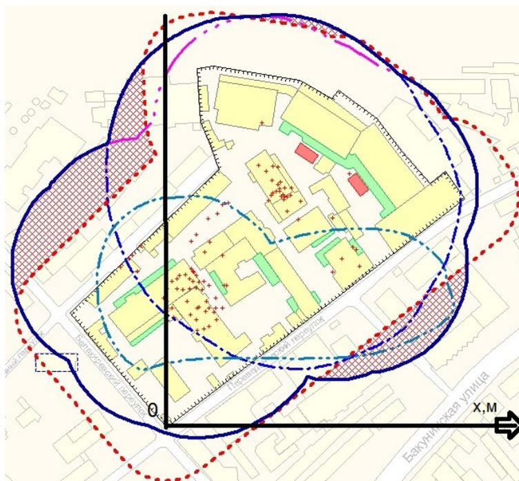
Рис. 2.4. Пример генплана с координатной сеткой, нанесенными источниками воздействия, границей СЗЗ
