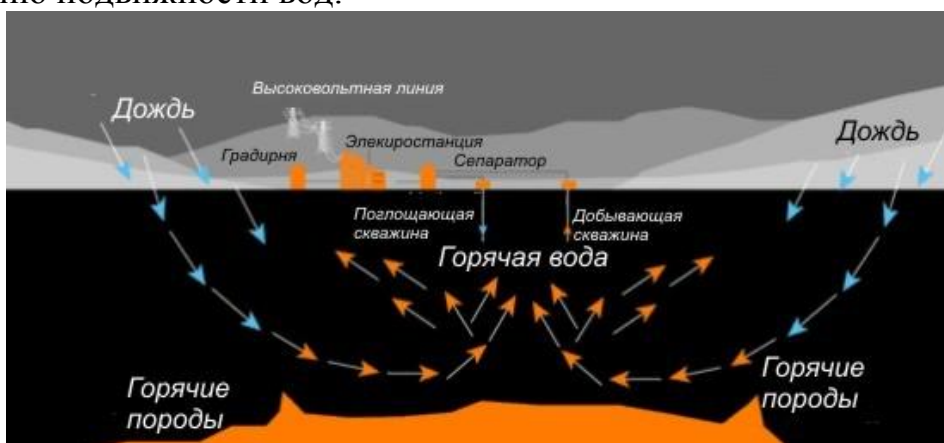
Рисунок 2.6. Схема формирования гидротермальных аномалий, используемых для извлечения геотермальных ресурсов
